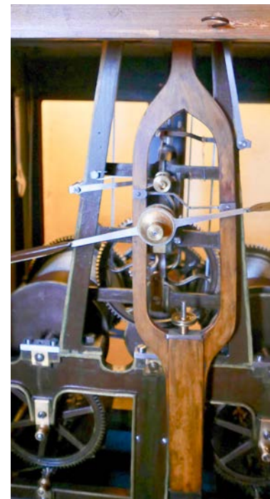
Ein Kunstwerk-das Uhrwerk mit den drei Walzen (hinten).
